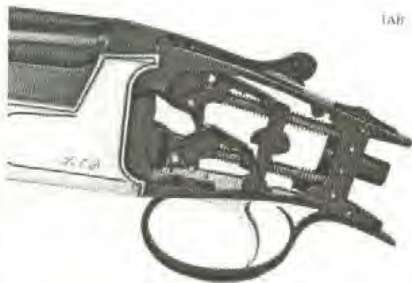
Udarni mehanizmi italijanske bokerice firme I. A. B.
